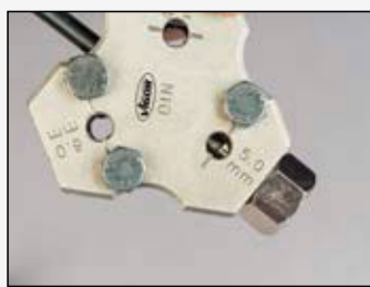
Позиционирование тормозной трубки для развальцовки
